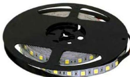
■ Tira de LED adhesiva, de alto rendimiento, para instalación en interiores IP20 y en exteriores IP65. La tira se suministra en bobina de 5m con cables de alimentación a 24V DC. Para instalación en perfilera de aluminio consultar perfiles.
