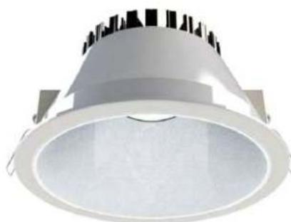
■ Downlight LED Ada. Instalación en interiores. Cuerpo principal de aluminio inyectado, acabado con pintura de poliéster al horno. Disipador de calor en aluminio anodizado. Lente de PMMA intercambiable.
