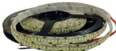
■ Tira de LED adhesiva, de alto rendimiento, para instalación en interiores IP20 y en exteriores IP65. La tira se suministra en bobina de 5m con cables de alimentación a 24V DC. Para instalación en perfilera de aluminio consultar perfiles.
