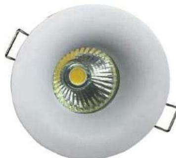
■ Empotrable Fijo Drop-2. Instalación en interiores. Cuerpo principal en aluminio fundido a baja presión, lacado en blanco con pintura epoxi y secado a alta temperatura. Fijación por muelles. Portalámparas GU10, tanto para lámparas halógenas o de LED.
