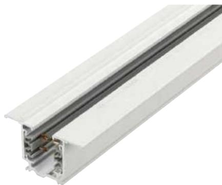
■ Estos railes tienen la función de proporcionar tanto el suministro eléctrico como el soporte mecánico de la luminaria en cualquier punto de su recorrido. En el interior del rail, cuatro conductores (Neutro, Fase 1, 2 y 3) ofrecen la posibilidad de tener tres encendidos independientes. La elección de encendido, Fase 1, 2 o 3 se hace por medio del conmutador de la luminaria. Cada uno de los tres circuitos puede ser conectado con 16A.
