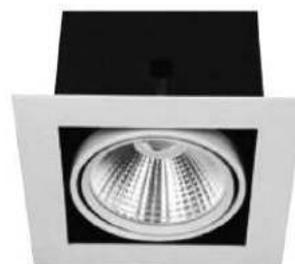
■ Empotrable Cuadra. Basculante. Instalación en interiores. Iluminación uniforme y sin deslumbramiento. Cuerpo principal y disipador en aluminio, acabado pintura de poliéster secado al horno en blanco.
