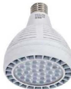
■ Lámpara PAR20 LED. Cuerpo en aleación de aluminio. Provista de un ventilador MAGLEV-FAN de SUNON para una óptima disipación de calor, que se activa con una temperatura superior a 90°.
