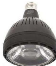
■ Lámpara PAR30 LED COB. Cuerpo en aleación de aluminio. Provista de un ventilador MAGLEV-FAN de SUNON para una óptima disipación de calor, que se activa con una temperatura superior a 90°.
