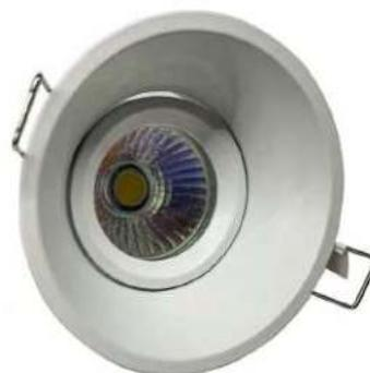
■ Empotrable Drop-4. Orientable y basculante 15°. Instalación en interiores. Cuerpo principal en aluminio fundido a baja presión, lacado en blanco con pintura epoxi y secado a alta temperatura. Fijación por muelles. Portalámparas GU10, para lámparas halógenas o de LED.
