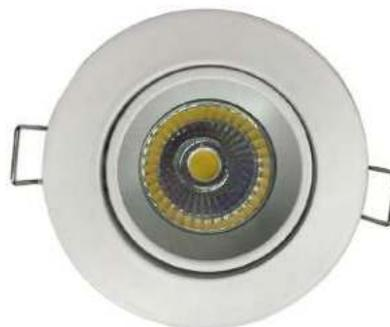
■ Empotrable Drop-1. Orientable y basculante 15°. Instalación en interiores. Cuerpo principal en aluminio fundido a baja presión, lacado en blanco con pintura epoxi y secado a alta temperatura. Fijación por muelles. Portalámparas GU10, para lámparas halógenas o de LED.
