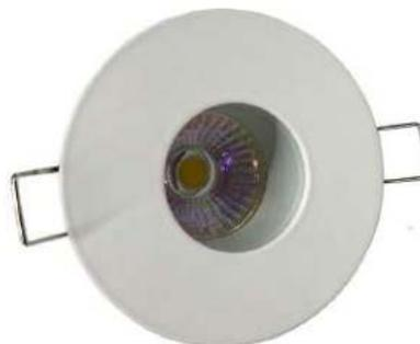
■ Empotrable Fijo Drop-3. Instalación en interiores. Cuerpo principal en aluminio fundido a baja presión, lacado en blanco con pintura epoxi y secado a alta temperatura. Fijación por muelles. Portalámparas GU10, tanto para lámparas halógenas o de LED.
